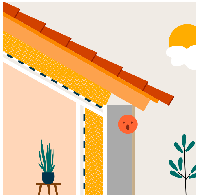
Étape 2 Isolation des murs par l'intérieur
