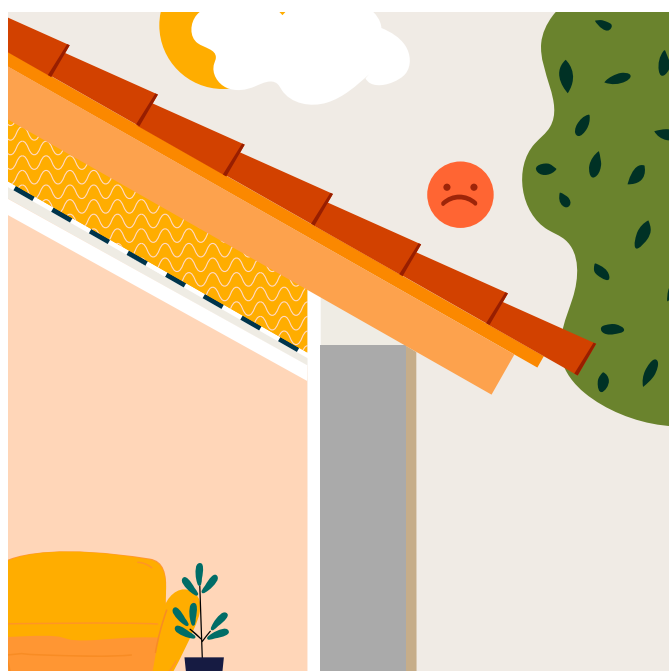
Étape 1 Isolation des rampants
