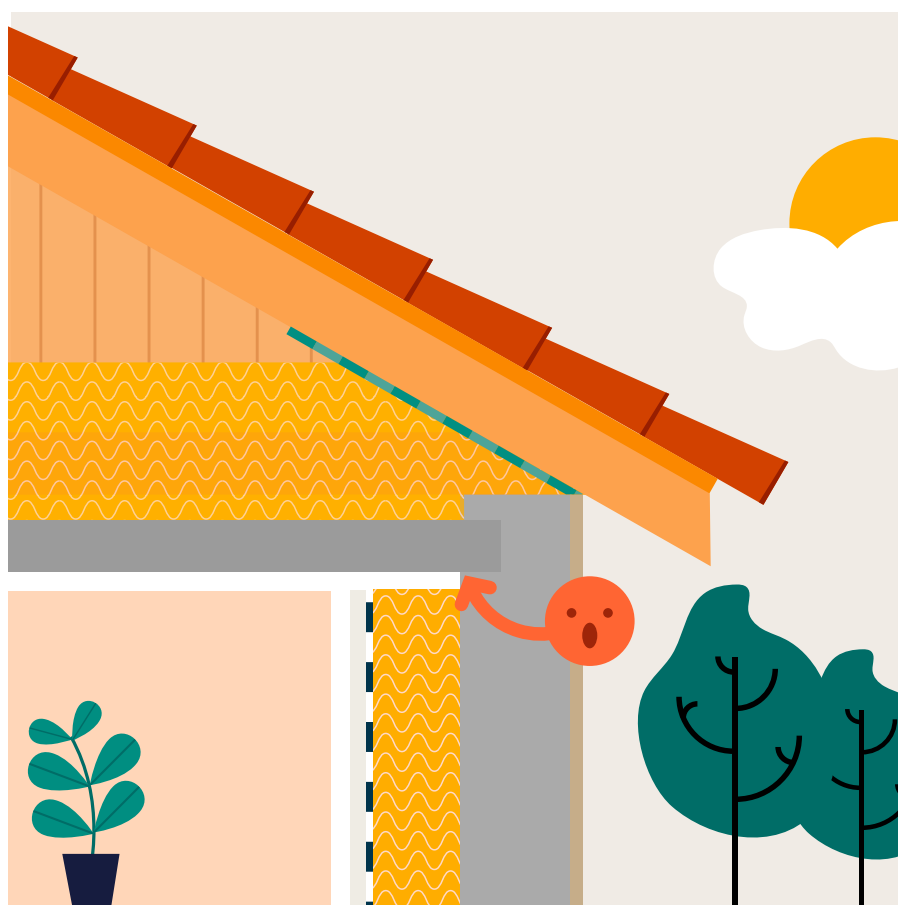
Étape 2 Isolation des murs par l'intérieur
