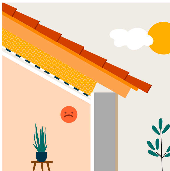
Étape 1 Isolation des rampants
