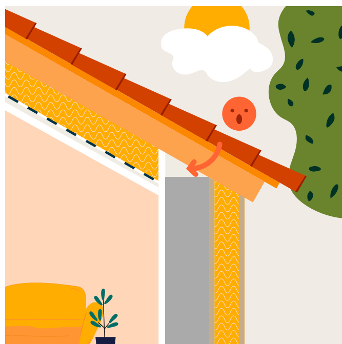
Étape 2 Isolation des murs par l'extérieur
